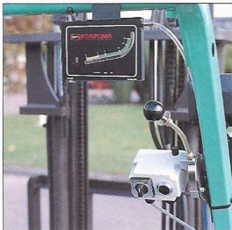
De vorkheftruckchauffeur kan vanaf zijn zitplaats de VS 1000 volledig bedienen. Aan- en uitschakelen, trilmotor bedienen en zelfs het openen van de vuilvergaarbak boven een container gaat vanaf de bestuurdersplaats op de vorkheftruck. De vacuummeter geeft de onderdruk van de stofafzuiging konstant aan.
