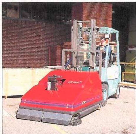
VS 1000 B: De uitvoering met benzinemotor, zodat de VS 1000 een eigen aandrijfbron heeft en deze onafhankelijk is van het type vorkheftruck. Voor iedere toepassing heeft Konfoma Industries B.V. een VS 1000.
