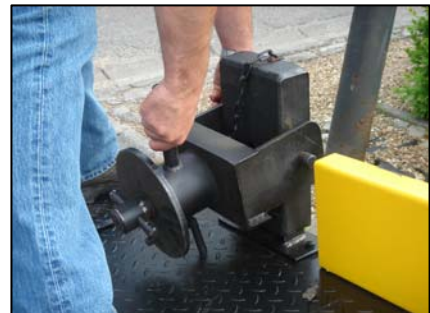
Stap 4 : Schuif de vorkklomp over de staaf aan de zijkant
