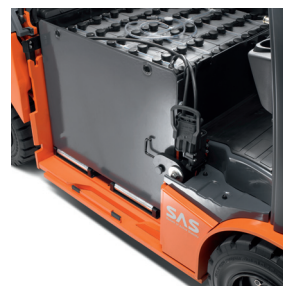
Zijdelings batterijwisselen met een rollenbed
