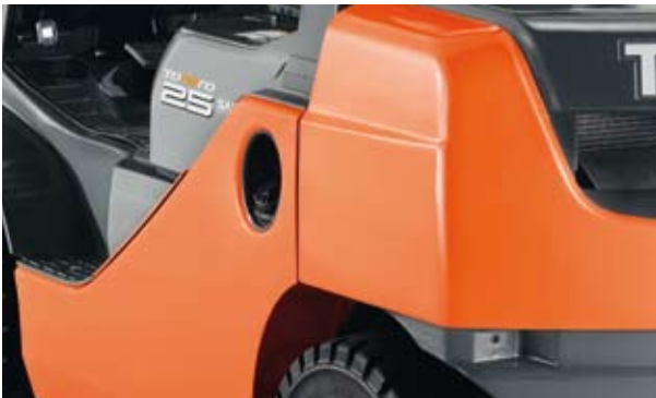
Robuuste stalen zijpanelen
