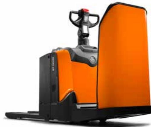
Standardausführung: nach oben klappende Plattform und leicht zu justierende Seitenschutzbügel
