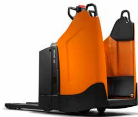
Optional: manuell hochklappbare Plattform, feste Rückenlehne, feste Seitenschutzwände
