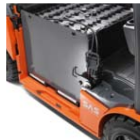
Zijdelings batterijwisselen met een rollenbed
